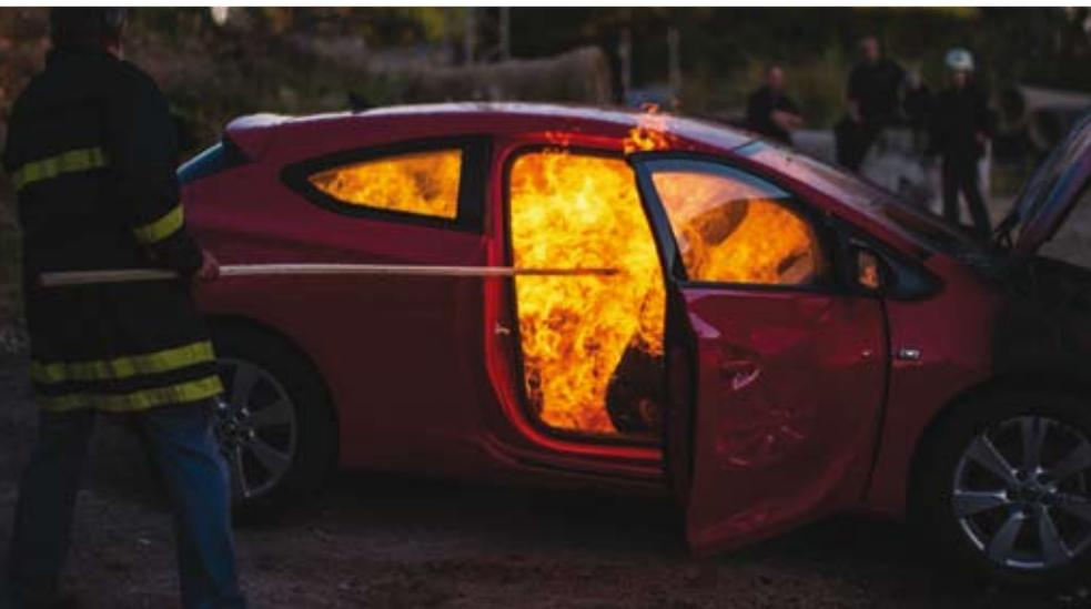
links: *Brandversuche zum Vorgehen bei PKW-Bränden*
